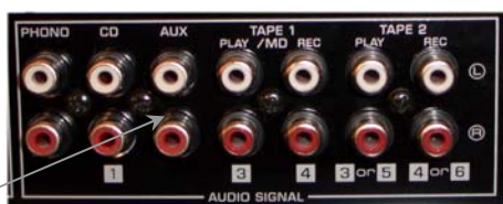
Ingångar för anslutning av Mottagare .se förstärkaren baksida
